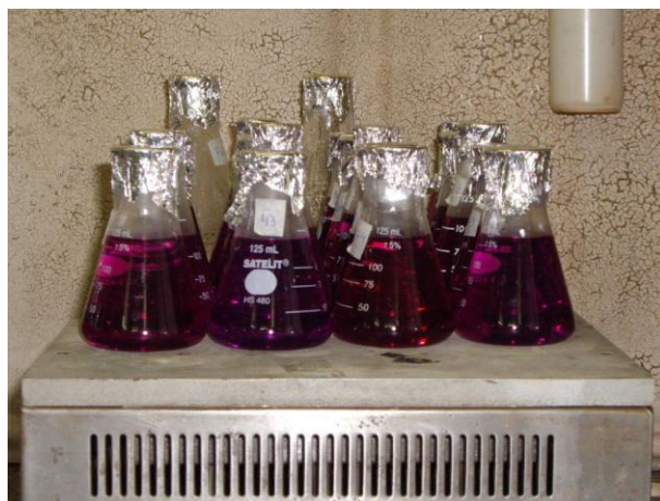
Figura 21: Análise de demanda química de oxigênio (DQO) na chapa quente.
