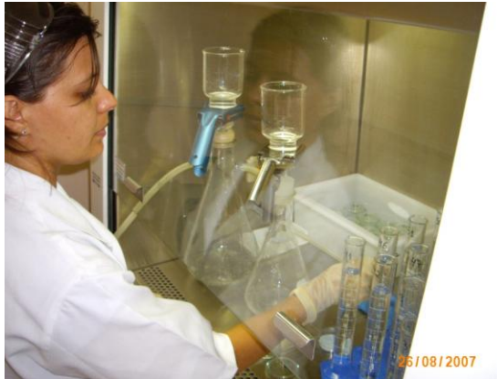
Figura 16: Sistema de filtragem a vácuo.
